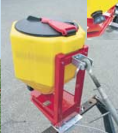
Frontanbau mit Oberlenkeranbau-konsole, Detail: Entleerungsöffnung
