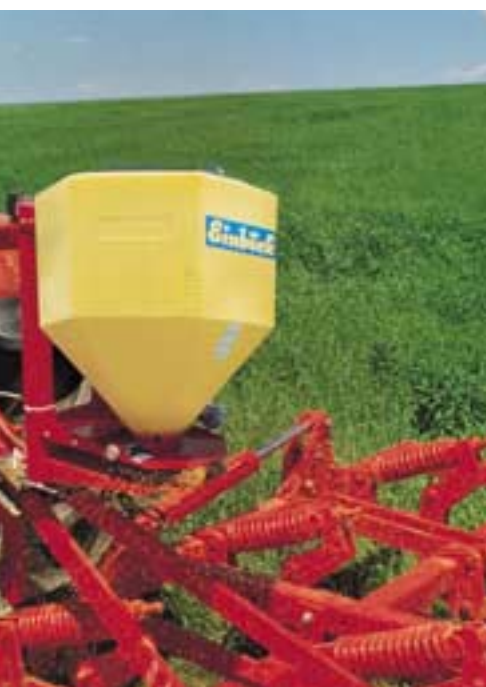
Rotoseeder aufgebaut auf Grubber
