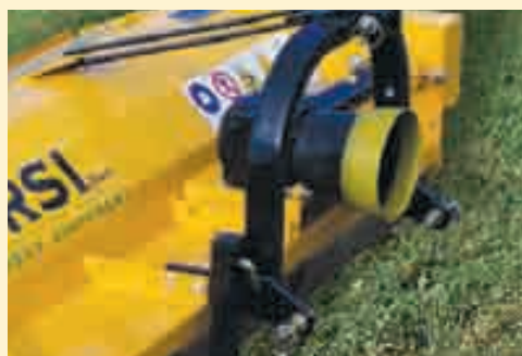
SPOSTAMENTO MANUALE MANUAL SIDE SHIFT DÉPORT MANUEL SEITENVERSETZUNG VON HAND DEPLAZAMIENTO MANUAL
