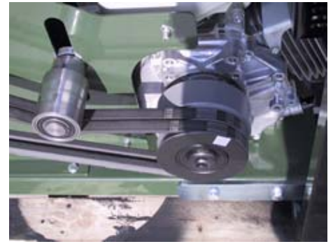
Riemenantrieb mit Fliehkraftkupplung
